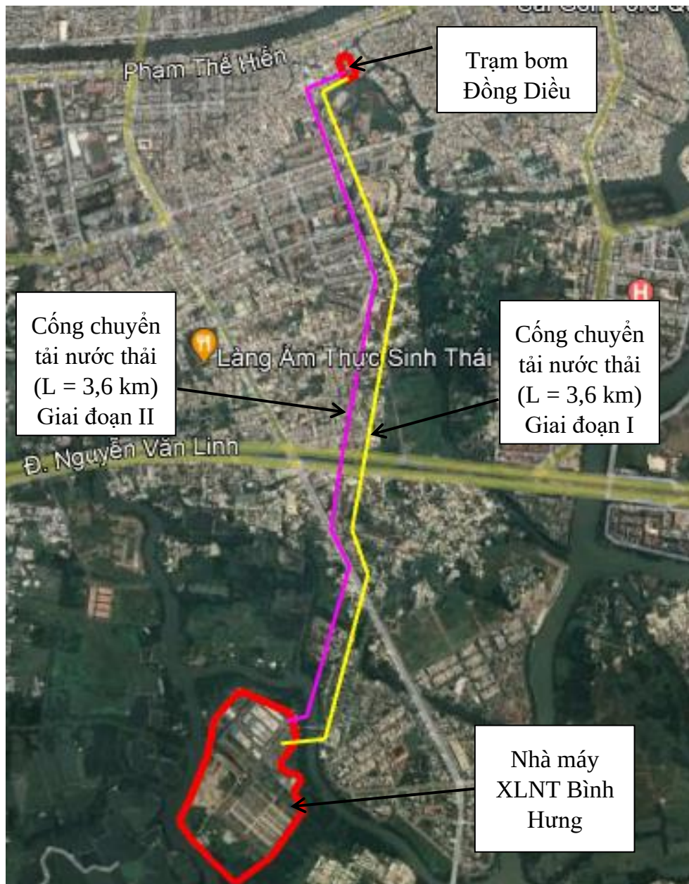
Hình 3.7. Vị trí thực hiện lắp đặt cổng chuyển tải nước thải từ Trạm bơm nâng Đồng Điều về Nhà máy XLNT Bình Hưng
