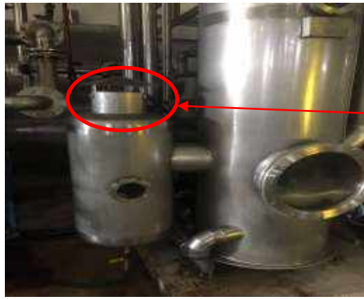
Hình 3.22 Vị trí ống xả khí CO 2 số 02 trong hệ thống thu hồi CO 2
