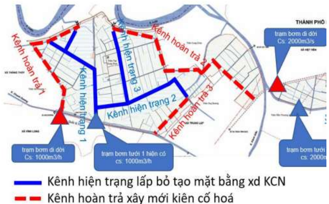
Hình 1.4: Tuyến kênh mương hoàn trả qua khu vực Dự án
